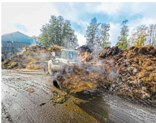
Der Rohstoff ist am Dampfen: Rund 15 Tonnen Dung und Stroh werden täglich in die Biogasanlage (hinten) gekippt.
